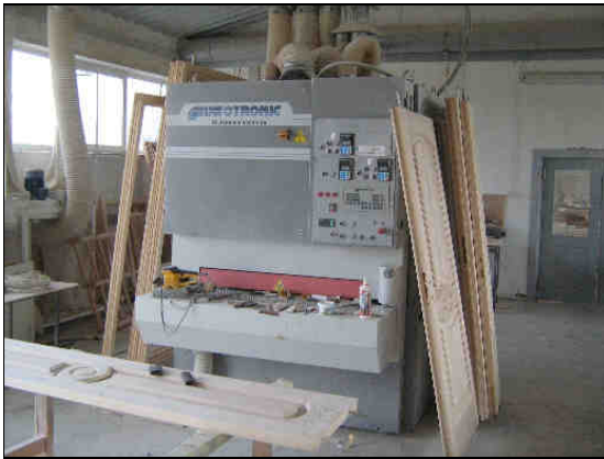
Brusilica za međufazno brušenje INFOTRONIC NEPTUN 115
