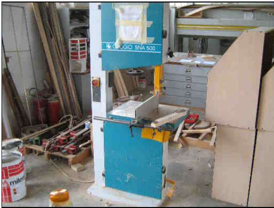
Trakasta testera GRIGGIO SNA 500
