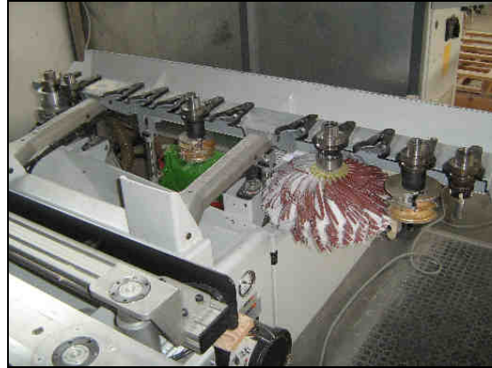
CNC glodalica HOLZ HER ECO MASTER 7120 i magacín alata sa 12 glava
