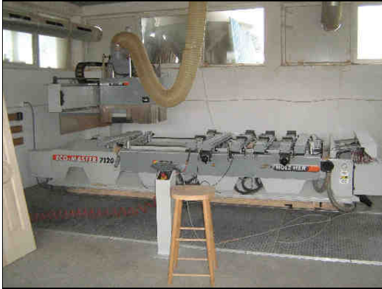
CNC glodalica HOLZ HER ECO MASTER 7120 i magacín alata sa 12 glava
